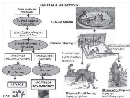
Σχ. 11. Αναπαράσταση της διαδικασίας ανακύκλωσης λιθαργύρου για παραγωγή αργύρου και εμπορικού μολύβδου. Αριστερά το διάγραμμα ροής και δεξιά αναπαράσταση του τεχνολογικού εξοπλισμού-εγκαταστάσεων που αντιστοιχούν σε κάθε στάδιο.
