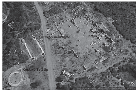
Σχ. 10. Ένα εξαιρετικό παράδειγμα συγκροτήματος για την ανακύκλωση του λιθαργύρου, όπως φαίνεται από δορυφόρο (Google Earth). Παρατηρούνται το κυκλικό τριβείο, το επίπεδο πλυντήριο και το συγκρότημα πολλών καμίνων. Αρύ 2, ανασκαφή Κ. Τσάιμου (Τσάιμου Γ.Κ., 2008).
